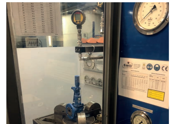
I vår separata avdelning för säkerhetsventiler testar och kontrollerar vi öppningstryck och täthet.
